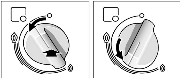
1. Нажмите переключатель конфорки нужной горелки и поверните влево на максимальную ступень мощности. Процесс поджига начнется после того, как будет нажат переключатель конфорки.
